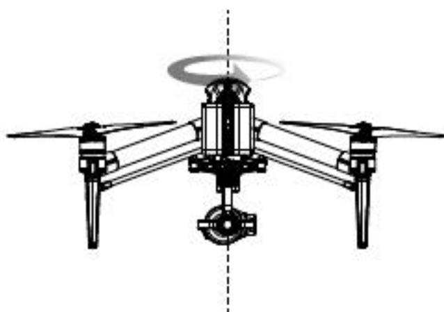
3. 機体の機首を下に向けて機体を垂直に保ち、中心軸周りに360度回転させます。機体ステータスインジケーターが赤色に点滅した場合、再度コンパスのキャリブレーションを実施してください。
