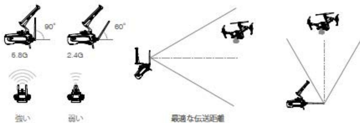
機体が最適な伝送範囲内で飛行するようにしてください。最適な伝送性能を実現できるように、操縦者と機体の位置と距離を調整してください。最適な伝送範囲に必要なアンテナの位置は、周波数(5.8Gおよび2.4G)に応じて異なります。実際の動作周波数に基づいてアンテナを配置してください。
