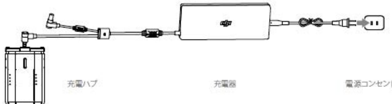
\* Inspire 2のインテリジェント・ライト・バッテリーを完全に充電するには約1.5時間、送信機を完全に充電するには約3時間かかります。インテリジェント・ライト・バッテリーと送信機を同時に充電すると、これより長い時間がかかります。
