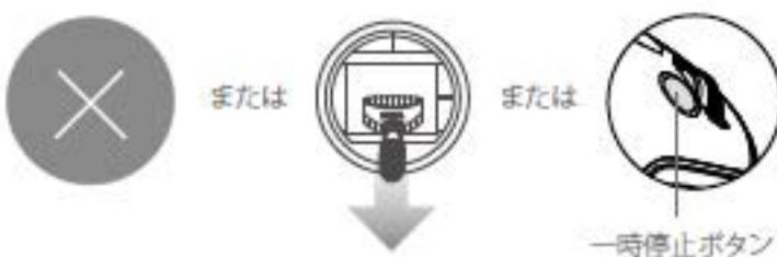
TapFly(タップフライ)を終了すると機体は停止し、ホバリング状態になります。新たな目的の方向をタップして飛行を続行するか、手動による飛行を行えます。
