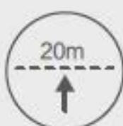
機体が高度20m未満で飛行中、フェールセーフ(スマートRTH、ローバッテリーRTHなど)が発動された場合、機体はまず現在の高度から20mまで自動で上昇します。この上昇は、フェールセーフを終了するとキャンセルできます。
